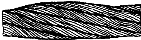
Рисунок 13. Местное увеличение диаметра каната
