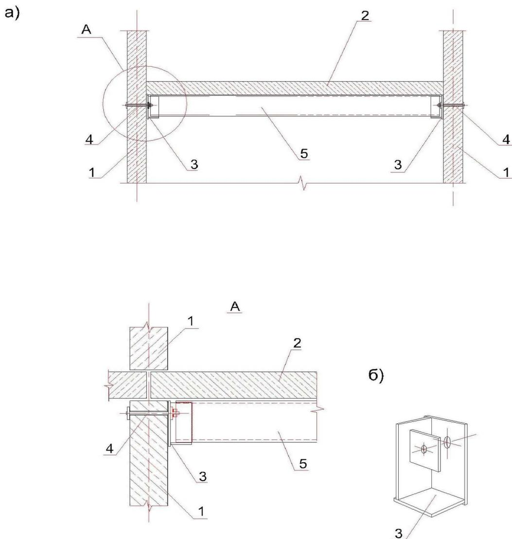
а) - разрез по перекрытию; б) - вид опорного столика
