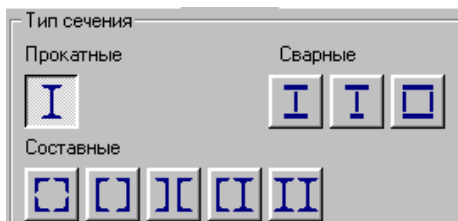
Рис. 6.5.3-1. Типы поперечных сечений колонны
