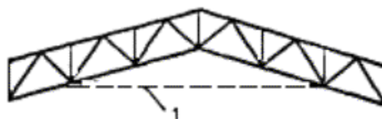
Рис. 47. Усиление фермы дополнительной затяжкой:
