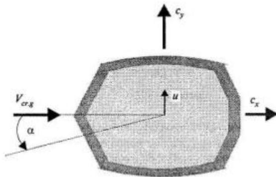
**Рисунок 4.5.** К определению критических скоростей ветра при галопировании
