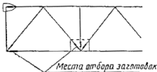
Рис. 8.6. Места отбора заготовок из элементов ферм
